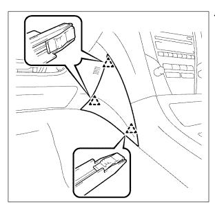
1. REMOVE THE INSTRUMENT PANEL FINISH PANEL END LH
